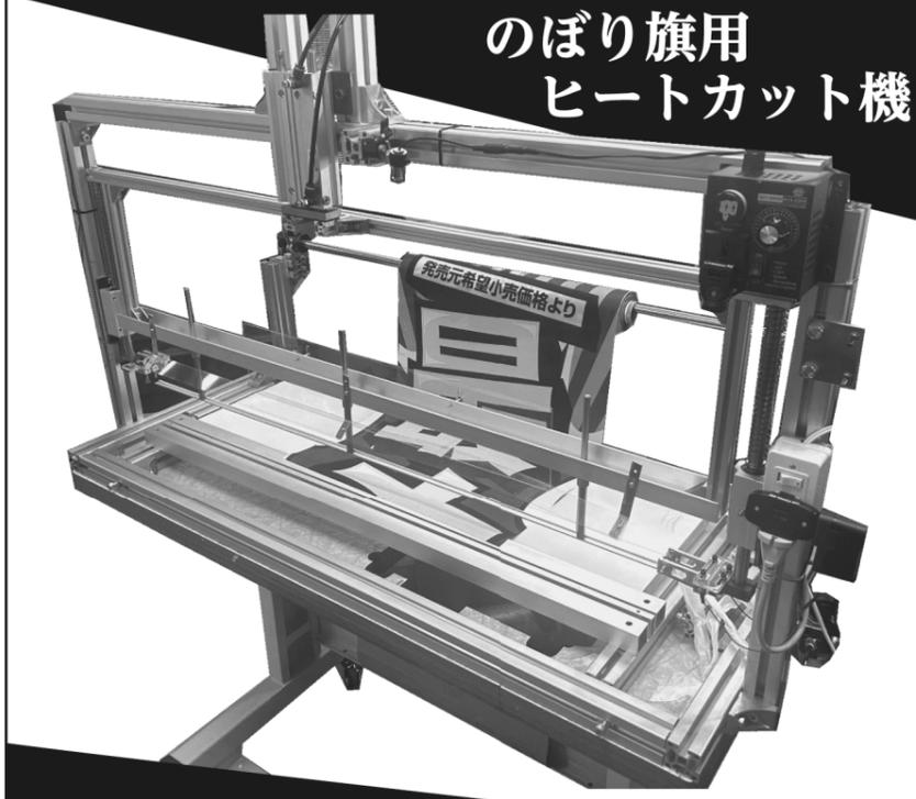
のぼり旗の反物をニクロム線にて熱カットし、ほつれを防止します。
