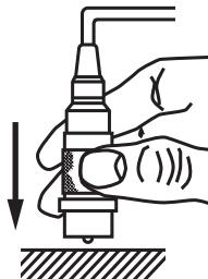
プローブの中央部分を左図のように持て、測定対象物表面に垂直に・素早く・静かに押し当てて下さい。
