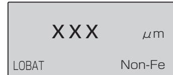
(乾電池の電圧低下表示)
