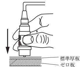
「 $\wedge$ 」・「 $\vee$ 」キー④を押してLCD⑦上の表示値を標準厚板の厚さに合わせます。
