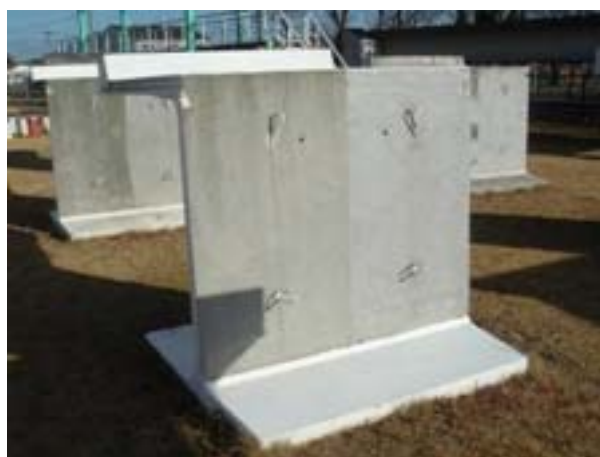
写真-IV.2.2 つくば暴露7年の大型試験体の外観
